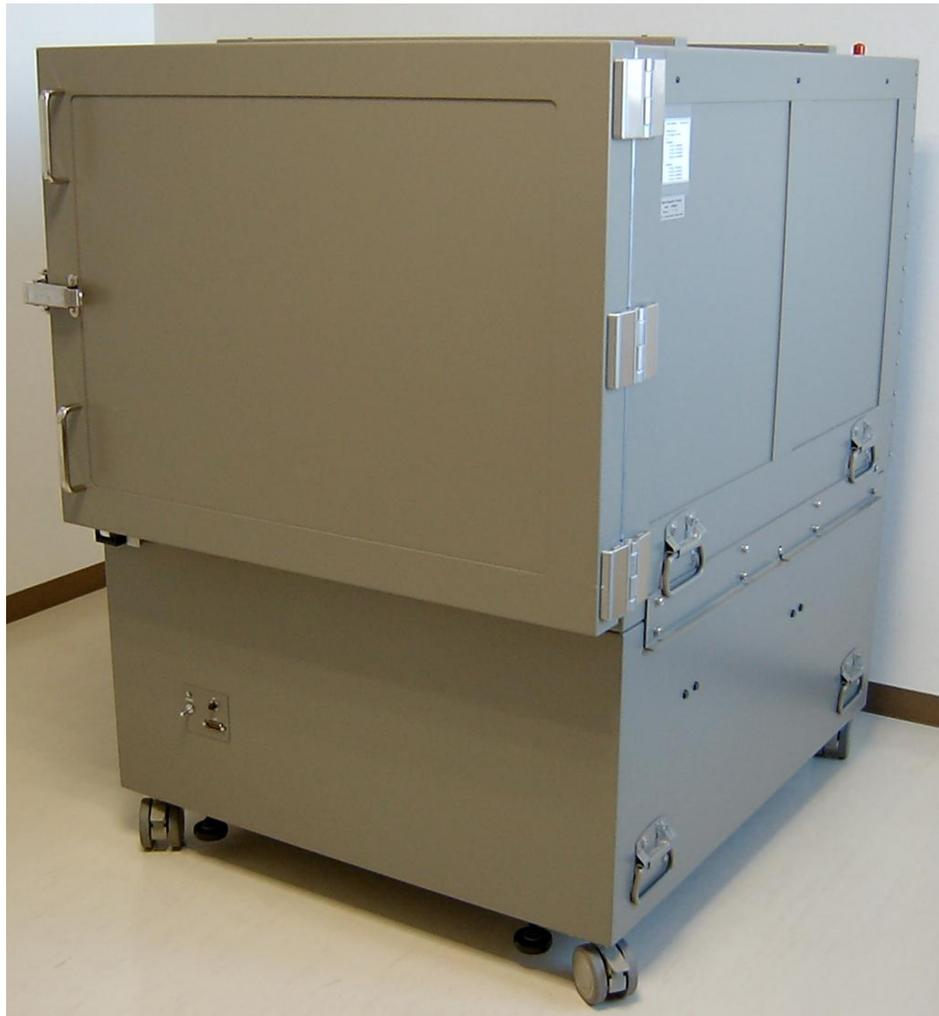
世界各国の 800MHz, 1.5GHz, 1.9GHz 帯 携帯電話機等移動端末機器の送信電波放射パターン測定及び受信感度パターン、受信諸特性測定等に開発された据置型擬似電波伝播路です。チャンバー内回転台には、各種携帯情報端末機器が設置でき、内部奥の壁面より垂直及び水平偏波の電磁波が内蔵放射アンテナより放射(受信)されます。また、特別仕様により GPS 等に対応する円偏波電磁のアンテナが内蔵されます。アンテナ内蔵型情報機器放射パターン、受信感度パターン等を迅速・簡便に行なう事を目的に製作された電磁波エアインターフェースです。
