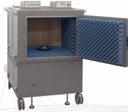
▲電磁波放射測定チャンバー
