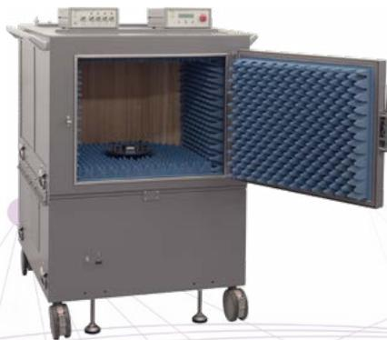
▲電磁波放射測定チャンバー
