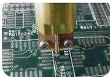
■ 先端部分が半円形にカットされているのでコンタクト部分の確認が容易
